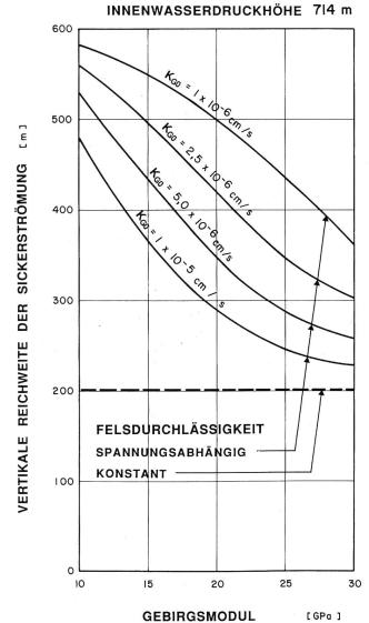
Bild 2. Vertikale Reichweite der Sickerströmung in Abhängigkeit des Gebirgsmoduls und der Gebirgsdurchlässigkeit ( $K_{\rm G0}=$  primäre Gebirgsdurchlässigkeit). Beispiel: Hochdruckstollen Collierville des Kraftwerks North Fork in Kalifornen.
