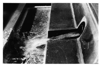
Bild 5. Impulswirkung beim Anschlussprinzip «Krümmer».
