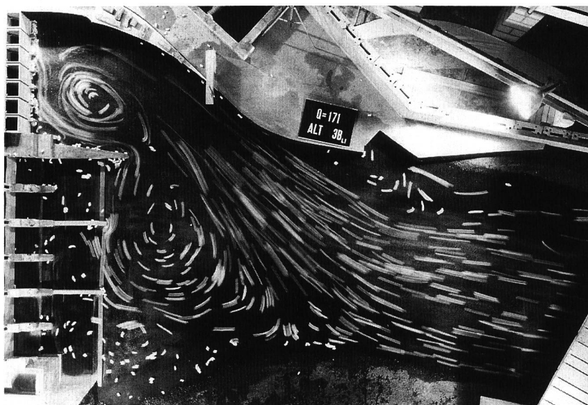
Bild 2. Am physikalischen Modell visualisierte Strömung unterhalb eines Flusskraftwerkes. Die numerische Modellierung ermöglicht zurzeit erste anwendbare Rechnungen für den Oberwasserbereich von Staustufen; der dargestellte Strömungstyp ist ein Problembeispiel für die nähere Zukunft.
