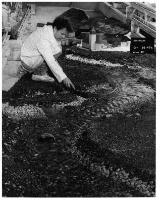
Bild 4. Entwicklung eines Hochwasserschutzprojektes im Raume Gurtnellen nach der Unwetterkatastrophe vom August 1987 (Modell der Reuss im Massstab 1:60).
