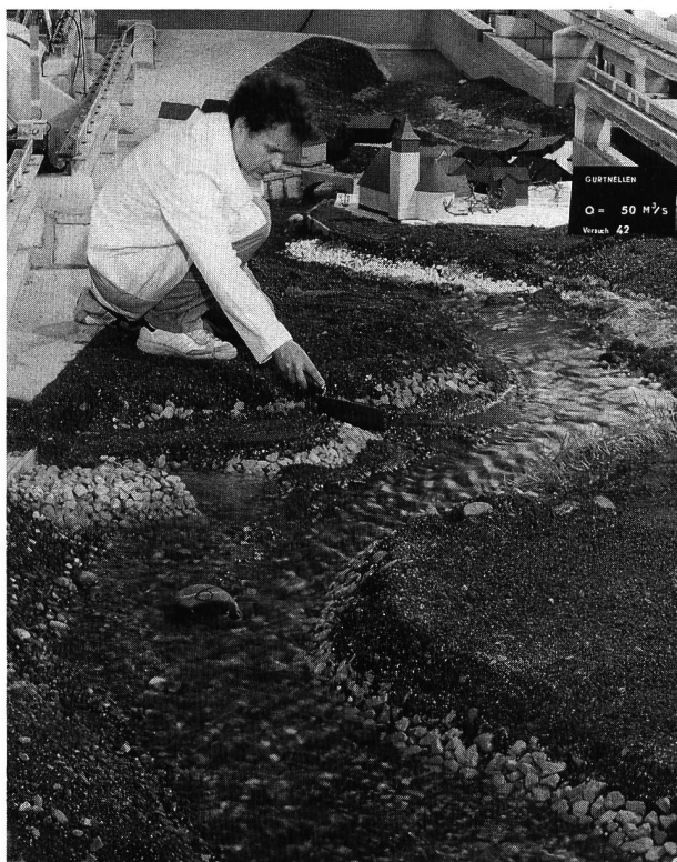
Bild 4. Entwicklung eines Hochwasserschutzprojektes im Raume Gurtneulen nach der Unwetterkatastrophe vom August 1987 (Modell der Reuss im Massstab 1:60).
