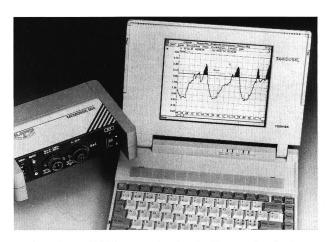
sung sowie vor Ort können entweder die Strom- oder die Spannungspegel erfasst werden. Dank modernster Technologie und der Programmierbarkeit der Memobox 604 können zudem auch bis zu 10 Zwischenharmonische sowie das Signal der Rundsteuerung gemessen werden.
