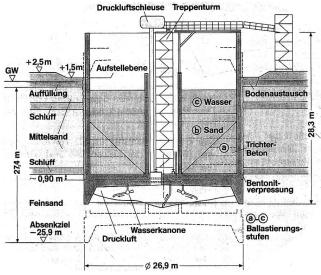
Bild 1. Oberirdisch als Caisson hergestelltes Regenrückhaltebekken mit Pumpwerk nach dem Absenken.
