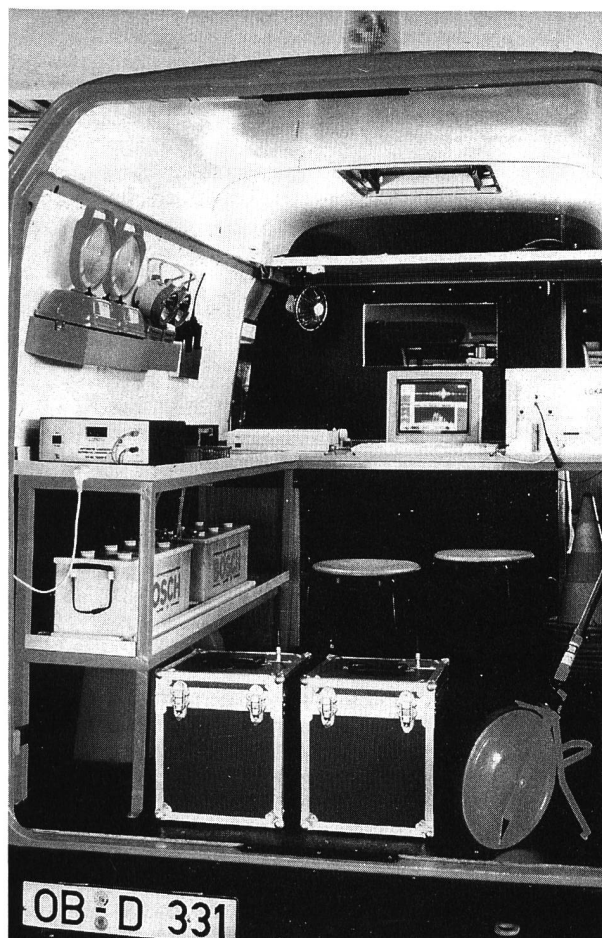
Bild 3. Eigens für die Leckortung auf Fernwärmeleitungen ausgerüstetes Messfahrzeug (Foto: EVO).
