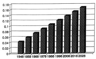
Bild 2. Voraussichtlicher Anstieg der Leckagen in relativen Einheiten für das öffentliche Wasserrohrnetz von New York [5].
