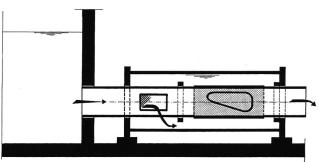
Bild 3. Schlauchdrossel neuerer Bauart, das heisst mit Versteifung an Rohrsohle und -scheitel.
