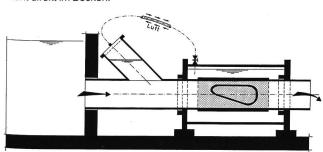
Bild 5. Seltener ist die Bauform Typ Y: Um Verschmutzungen vorzubeugen, wird der Aussendruck über eine Luftleitung übertragen. Heute gelangt allerdings in kritischen Fällen normalerweise der U-Typ zur Anwendung.
