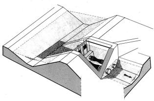
Bild 7. Konstruktiver Vorschlag eines Bauwerkes in der Bewässerungstechnik (nach *Vischer* und *Peter,* 1985). Man beachte die grundsätzliche Möglichkeit, Drosseln in der Höhe gestaffelt oder nach Durchmessern abgestuft anzuordnen.
