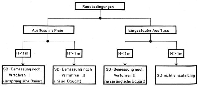
Bild 10. Grundschema für die Wahl der Berechnungsverfahren. Wesentlich ist, ob die Schlauchdrossel von unten eingestaut ist oder nicht. Kleine Überdrücke werden mit Drosseln ohne Versteifung (ursprüngliche Bauart) bewältigt; Normalfall stellt aber die versteifte neue Bauart für höhere Drücke dar.
