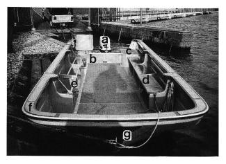
Bild 2. Innenansicht des Bootes: a) Motor mit Pinnensteuerung, b) Kasten mit Stauraum, c) Kasten mit 2x20-l-Tank, d) Sitzbank oder e) Alurohre zur Befestigung von Transportgut oder Arbeitsbühne, f) Abdeckung der Bordkante mit rostfreiem Stahl, g) Verkleidung des Kiels mit rostfreiem Stahl.
