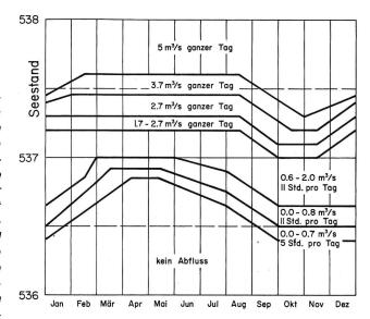
Bild 2. Der Zonenplan mit 8 Zonen des seit 1990 gültigen Wehrreglementes zur Regulierung des Pfäffikersees vereinfacht dargestellt. In jeder Zone sind die Seeausflüsse in Funktion des Sestandes und der Jahreszeiten unterschiedlich festgelegt. In den unteren Zonen mit variablen Werten werden die Seeausflüsse unter Berücksichtigung des Wildbachabflusses für die Wasserkraftanlagen optimiert.
