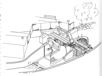
Bild 3. Perspektivische Darstellung der Wehranlage. Links das neue Wehr mit der Geschwemmselbeseitigungsanlage und mit dem Segmentschütz. Im Mittelpfeiler die Fischtreppe. Rechts das alte Wehr mit zwei hintereinanderliegenden Tafelschützen.
