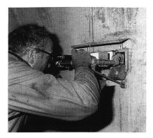
Bild 5. Ablesung einer Lotdrahtposition.
