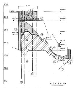
Figure 6. Surélévation de l'évacuateur de crues
