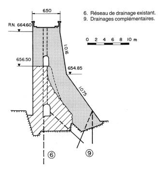
Figure 5. Surélévation, plot de rive de hauteur inférieure à 20 m.
