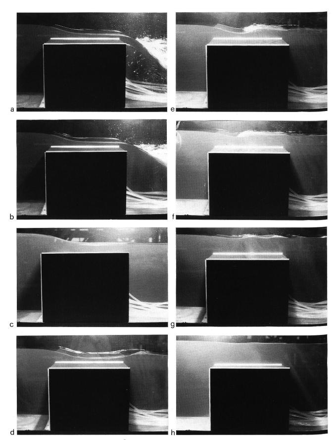
Bild 5. Einstauverhältnisse beim breitkronigen Überfall.  $y_t = a) 0.03$ , b) 0.20, c) 0.52, d) 0.68, e) 0.78, f) 0.85, g) 0.90, h) 0.95.
