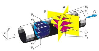
$$Q = \int_{y} \left[ \int_{x} v(x, y) dx \right] dy \qquad v(x, y) \text{ beschreibt das Geschwindigkeitsprofil}$$
