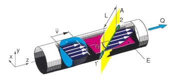
Die Schallfortpflanzungsgeschwindigkeit wird durch die Strömung beeinflusst:
