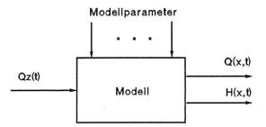
Bild 10. Modell mit verteilten Parametern bzw. System partieller Differenzialgleichungen.
