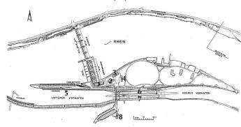
Bild 15. Lageplan. 1 Dienstgebäude, 2 Schalthaus, 3 Pumpenhaus und Garagen, 4 AEB (Alternative Energie Birsfelden), 5 Pegelstation Unterwasser, 6 Schleuse Nord, 7 Schleuse Süd, 8 Verwaltung.
