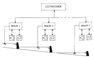
Bild 13. Konzept einer Wasserhaushaltautomatik für Staustufenketten.
