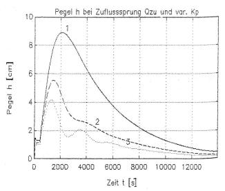
Bild 12. Beispiel: Pegelverhalten bei einem Zuflusssprung.
