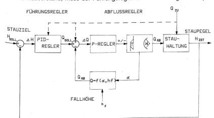
Bild 1. Regelkreis eines Laufkraftwerkes.
