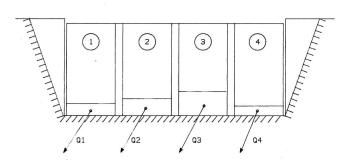
Bild 6. Vorlaufschaltung bei mehreren Wehrfeldern.
