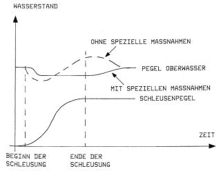
Bild 8. Pegelverhalten bei einer Schleusenfüllung.
