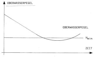
Bild 4. Oberwasserpegel im Schwellbetrieb.
