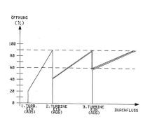
Bild 3. Turbinenregime unter Berücksichtigung des Wirkungsgrades.
