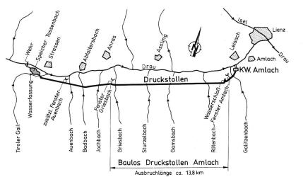
Bild 1. Druckstollen Amlach für das Kraftwerk Strassen-Amlach.
