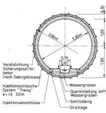
Bild 2. Regelquerschnitt des Druckstollens.
