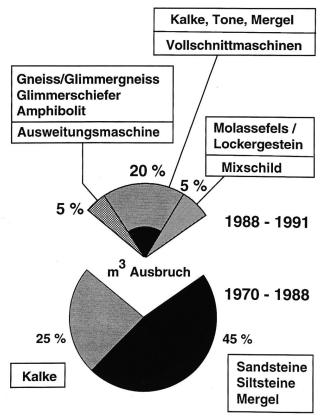
Bild 1. Gesteinsarten der 1970 bis 1988 in der Schweiz mit grossen Durchmessern aufgebohrten Tunnel.
