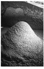
Bild 1. Silicamodifizierter Nassspritzbeton, im Feucht-Dünnstrom-Spritzverfahren über 40 cm dick in einem Arbeitsgang aufgetragen.
