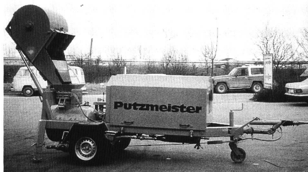
Bild 3. Betojet Typ 250 EHM mit Zwangs-Hubmischer (250 l).
