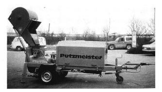
Bild 3. Betoiet Typ 250 EHM mit Zwangs-Hubmischer (250 I).
