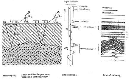
Bild 2. Schematische Darstellung des Kartierungsvorganges mit Georadar.
