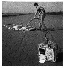
Bild 1. Die Messapparatur «Georadar 1, OYO». Auf einer Art Schlitten sind links der Empfänger und rechts der Sender angeordnet. Auf der Kontrolleinheit im Vordergrund ist der Kontrollbildschirm (links) zu erkennen. Darunter ist ein Drucker angeordnet und rechts davon das Bedienungsfeld.
