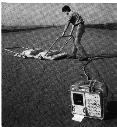
Bild 1. Die Messapparatur «Georadar 1, OYO». Auf einer Art Schlitten sind links der Empfänger und rechts der Sender angeordnet. Auf der Kontrolleinheit im Vordergrund ist der Kontrollbildschirm (links) zu erkennen. Darunter ist ein Drucker angeordnet und rechts davon das Bedienungsfeld.
