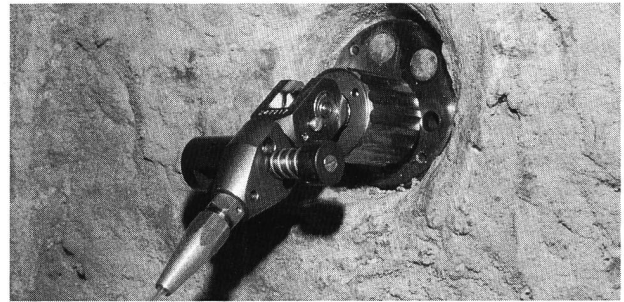
Bild 7, links. Deformation mit und ohne Berücksichtigung der Bewegung des Verankerungspunktes in 16 m Tiefe. Bild 8, rechts. Kupplungsstück zwischen Extensometer und Konvergenz-Messstrecke.
