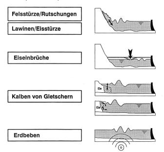
Bild 1. Auslösemechanismen von Schwallwellen.
