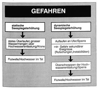
Bild 3. Auswirkungen der Schwallwellen in Stauseen.
