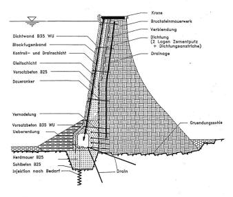
Querschnitt durch die Mauer mit Vorsatzschale (Hohlkasten)
