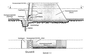
Bild 3. Varianten der Ausführung von Dichtwänden für durchströmte Bruchsteinmauern [4]: Konzept I (oben) einer statischen Betonverstärkung, durch Gleitfolie von der eigentlichen Dichtwand getrennt; Konzept II (unten) einer integralen Dichtwand, gewichtserhöhend aufgehängt mit Basisfuge.
