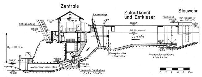
Bild 3. Längsschnitt A-A durch Einlaufbauwerk, Zulaufkanal, Zentrale und Unterwasserstollen der Neuanlage.
