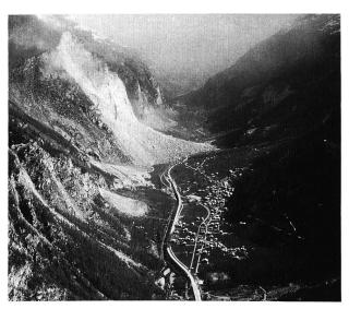
Bild 2. Am 18. April 1991 stürzten ca. 15 Mio m³ Fels zu Tal, und am 9. Mai 1991 erfolgte ein zweiter Abbruch von ungefähr gleicher Kubatur. Durch den Schuttkegel wurde die Vispa zugeschüttet und zurückgestaut. Bahnlinie und Strasse nach Zermatt wurden unterbrochen.
