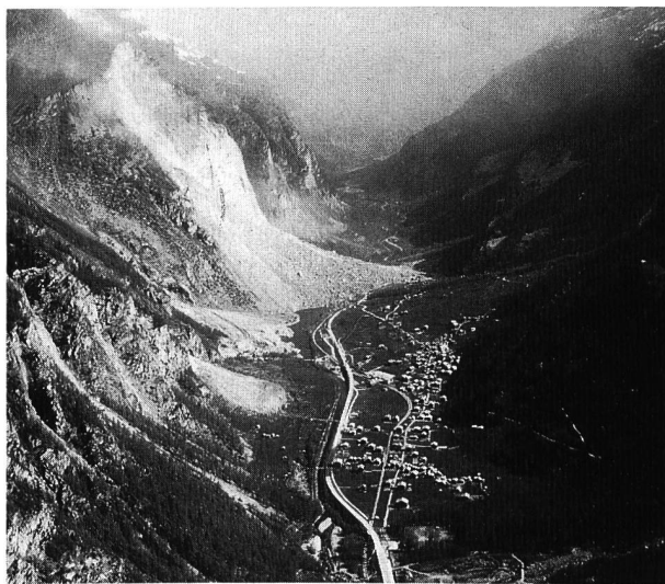
Bild 2. Am 18. April 1991 stürzten ca. 15 Mio m 3 Fels zu Tal, und am 9. Mai 1991 erfolgte ein zweiter Abbruch von ungefähr gleicher Kubatur. Durch den Schuttkegel wurde die Vispa zugeschüttet und zurückgestaut. Bahnlinie und Strasse nach Zermatt wurden unterbrochen.
