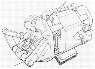
Bild 1. Unterwasser-Roboterfahrzeug (SID) zur Inspektion von Offshore-Konstruktionen.
