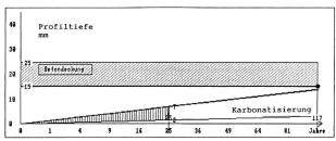
Bild 1. Analyse der Karbonatisierung an einem chloridbelasteten Bauteil.
