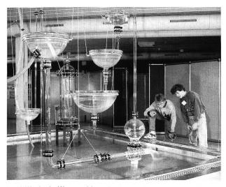
Bild 2. Was ist der Wasserschlosseffekt? Wie funktioniert der hydraulische Widder und die Heronspumpe? Eine Experimentieranlage aus Spezialglasgefässen und -röhren zeigt, wie es geht.
