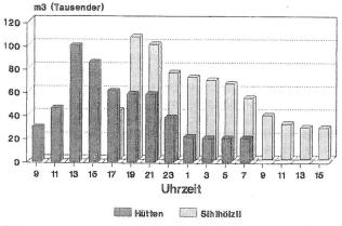
Bild 2. Schwallversuch an der Sihl vom 28. und 29. Juni 1990. Wassermenge in 1000 m³.
