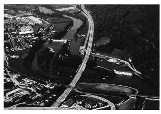
Bild 1. Das Kraftwerk Ruppoldingen, eines der ersten grösseren Kraftwerke der Schweiz. Links oben das Stauwehr, anschliessend rechts der Kanal, wie er damals bei Kraftwerken üblich war. Im alten Aarelauf unterhalb des Stauwehrs liegen die Ruppoldinger Inseln.
