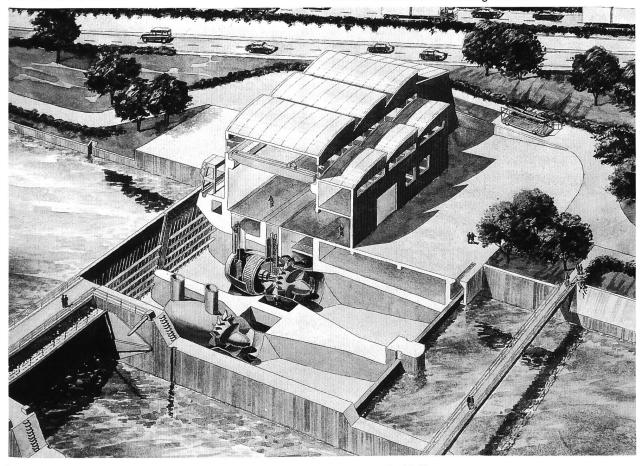
Bild 2. Zwei moderne Rohrturbinen vermögen im neuen Kraftwerk Ruppoldingen bis zu 450 m³/s Wasser zu verarbeiten und jährlich durchschnittlich 115 Mio kWh Strom zu produzieren. Dies ist fast dreimal soviel wie heute.
