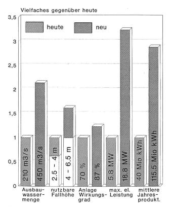
Bild 5. Gegenüberstellung der Hauptdaten. Heutiges Kraftwerk Ruppoldingen – Neubau Kraftwerk Ruppoldingen.
