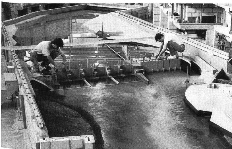
Bild 1. An hydraulischen Modellen werden Details von Strömungsvorgängen untersucht. Im Bild Modell 1:60 der Stauanlage Eglisau im Hinblick auf einen Umbau des Flusskraftwerks.
