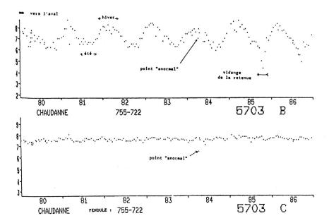
Figures 8 et 9. Barrage de Chaudanne. Ces deux graphiques montrent la visualisation obtenue à l'écran par le logiciel de traitement Calipso en haut en mesures brutes, en bas en mesures corrigées des efforts hydrostatiques et saisonniers. Le point anormal d'avril 1984 qui disparaît dans le nuage des mesures brutes est nettement mis en évidence sur le graphique des valeurs corrigées.
