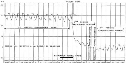
Figure 5. Barrage de Zeuzier. Evolution des déformations radiales mesurées – pendule médian (P2) – niveau 1740,40 – période: octobre 1964 à décembre 1989.
