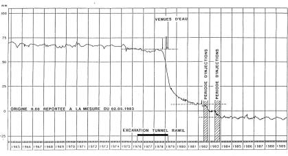
Figure 6. Barrage de Zeuzier. Déformations de comparaison théoriques radiales – pendule médian (P2) – niveau 1740,40 – période: octobre 1964 à décembre 1989.
