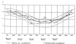
Fig. 2. Exemple de contrôle de plausibilité du type historique. Température du béton—thermomètre T8—cote 1296—période juillet: 1986 à juin 1991.
