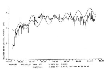
Figure 9. Exemple d'analogie statistique de type non adéquat. Le calcul harmonique indique une tendance à l'augmentation alors que le phénomène s'est stabilisé depuis cinq ans déjà.
