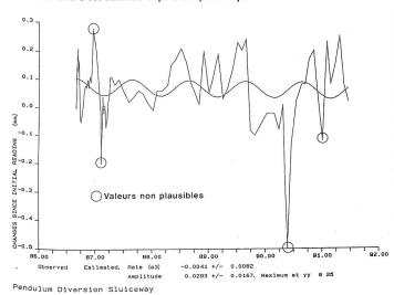
Figure 10. Exemple de contrôle de plausibilité non effectué. On n'a appa-
