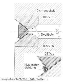
wegungen bis zu 1 m in der Höhe, bis zu 2 m in der Oberstrom-/Unterstromrichtung und bis zu 40 cm parallel zur Mauerachse ohne Verlust seiner Dichtungswirkung folgen. Diese Gleitfuge mit Dichtungskeil (Dreikantbalken) ist das Merkmal des Clyde-Dammes (Bild 5). Ein Dichtungskeil dieser Grösse wurde erstmalig in der Welt beim Clyde-Dammangewandt.
