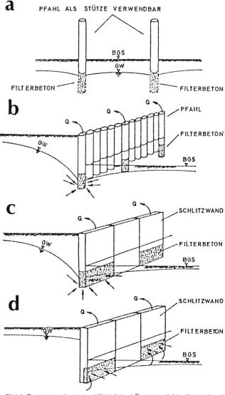
Bild 1. Drainageverbauarten (*Wieteke*). a) Drainagepfahl, alleinstehend, b) Drainagepfahlwand, c) Drainagewand, zweiseitig, d) Drainagewand, einseitig.
