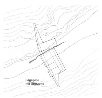
Bild 3. Störzone unter dem Clyde-Damm (Lageplan).
