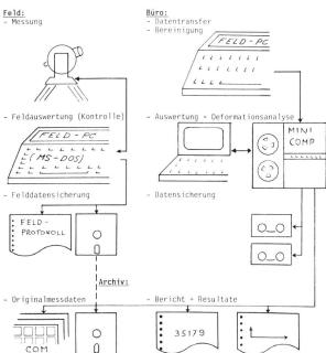
Bild 2. Geodätische Messdatenerfassung im Feldbuch (früher) und mit automatischem Datenfluss (heute).
