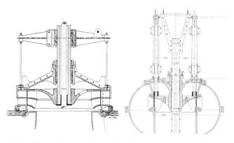
Bild 1, links. Zylinderschütze als Regulierorgan einer doppelflutigen Francisturbine, Baujahr 1896,  $P=75~\mathrm{HP},\,H=6~\mathrm{m},\,D_{\mathrm{Laufrad}}=1,\!18~\mathrm{m},\,\mathrm{aus}$  [3].
