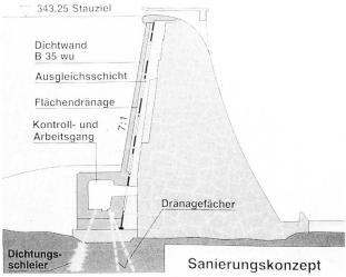
Bild 1. Instandsetzung einer alten Gewichtsmauer aus Bruchstein mit einer oberwasserseitigen Stahlbetondichtwand und Drainschicht sowie Dichtungsschleier.
