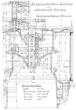
Bild 3. Glommen-Zylinderschütze, erstmals Ausbildung einer besonderen Fussform der Schütze zur Verminderung strömungserregter Schwingungen,  $P=3850~\mathrm{HP},~H=18~\mathrm{m},~\mathrm{aus}~[2].$
