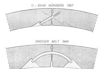
Bild 2. Längsfugen und Ringverschraubungen bei Stahlbetontübbingen.
