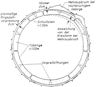
Bild 4. Spreiztübbinge (flexible epanded lining).
