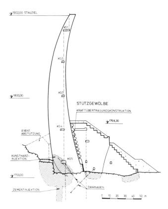
Bild 1. Sanierung der Kölnbreinsperre mit einem luftseitigen Stützgewölbe und Stabilisierung der Risszonen durch Injektionen (Projekt Mai 1988).
