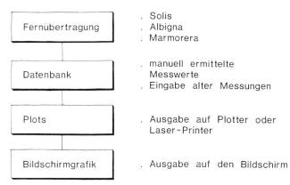
Bild 8. Die Hauptmodule der Software «Talsperren-Überwachung», die in Zürich eingesetzt wird.
