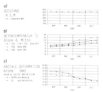
Bild 9. Die Software gestattet das Aufzeichnen von zwei beliebigen Variablen. In diesem Beispiel sind Messwerte in Funktion der Zeit dargestellt: a) Seestand, b) Betontemperaturen, c) radiale Deformation.
