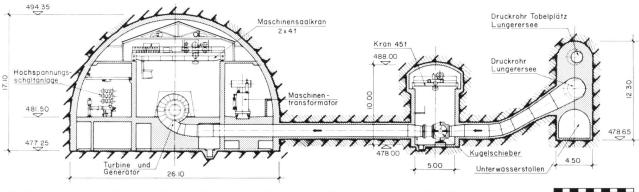
Bild 3. Kavernenzentrale Unteraa – Querschnitt durch Maschinenkaverne, Schieberkammer und Verteilleitungen.
