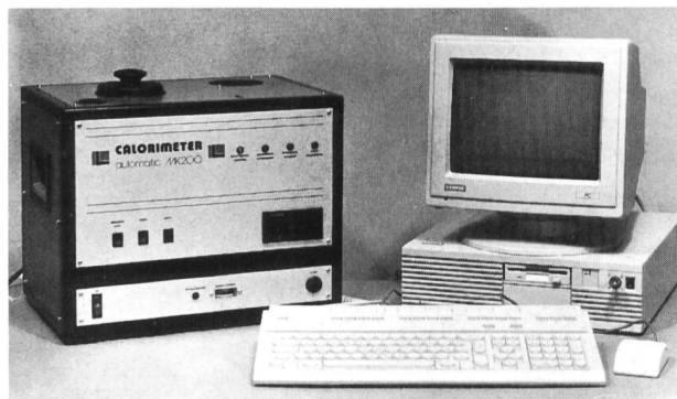
Morat-Verbrennungskalorimeter von Ingtec AG, Möhlin.
