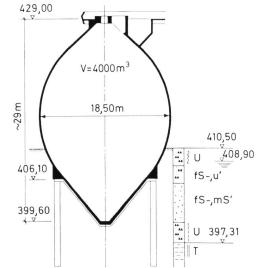
Bild 1. Faulbehälter mit Vorspannung ohne Verbund (Neumarkt)
