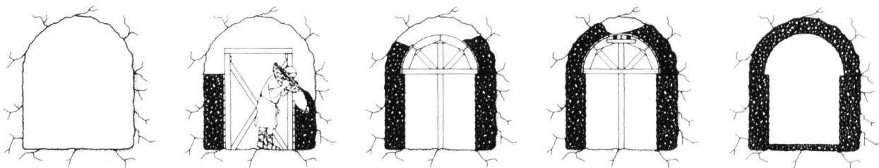
Bild 2. Bau einer römischen Wasserleitung – Tunnelstrecke mit Betonauskleidung.
