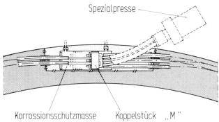
Bild 2. Blockverankerung mit vier Litzen 0,6 $^{\prime\prime}$  Durchmesser, St 1570/1770 ohne Verbund.
