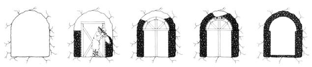
Bild 2. Bau einer römischen Wasserleitung - Tunnelstrecke mit Betonauskleidung
