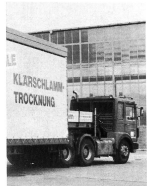
Bild 2, rechts. Transport einer mobilen Klärschlamm-trocknungsanlage mit Tieflader. (Fotos: U. Ammann)
