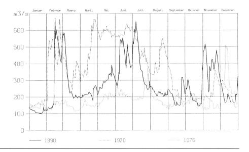
Abflussmenge der Aare bei Murgenthal. Einzugsgebiet 10148 km², Vergletscherung 2,4%. Jahresabflussmenge 1935–1990 286 m³/s, Jahr 1990 277 m³/s.
