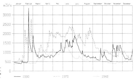
Abflussmenge des Rheins bei Rheinfelden. Einzugsgebiet 34550 km². Vergletscherung 1,3%. Jahresabflussmenge 1935–901035 m³/s; Jahr 1990 912 m³/s.
