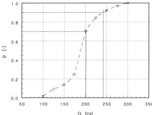
Bild 2. Häufigkeitsdiagramm für Fraktionen zu 25 I/s, oben, und unten Summenkurve der Mindestabflüsse gemäss der Methode nach *Schälchli* (1991, unveröffentlicht) für den Campo-Bach. *p:* Häufigkeit [–]; *Q:* Mindestabfluss [I/s]; *n:* Anzahl Fälle.
