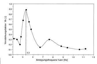
Bild 7. Resonanzkurve für die untere Schütze bei vertikaler Anregung. Die Schütze hängt frei in der Luft, die Öffnung der unteren Schütze beträgt ca. 1.0 m.
