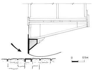
Bild 15. Mögliche Verbesserung der Geometrie der Schützenlippe. Der Ausflussstrahl wird sich bei dieser Ausbildung der Lippe an einem klar fixierten Punkt ablösen.
