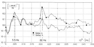
Bild 12. Naturmessungen, Schwingungszustand: untere Schütze 36 cm, obere Schütze 1,5 m geöffnet. Leistungsspektren der Geber h (untere Schütze, vertikale Messrichtung) und k (untere Schütze, Mitte unterster Hauptträger, horizontale Messrichtung). Die Spitzen bei den Frequenzen der beiden Hauptschwingungsformen (5,5 Hz vertikal und 22 Hz horizontal) sind deutlich sichtbar.
