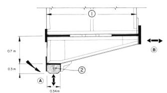
Bild 2. Detail der Schützenlippe der unteren Schützentafel. 1 Parabel-förmiger Hauptträger, max. statische Höhe 2,4 m, 2 Sohldichtungsbalken aus Eiche. Mit A und B sind die Positionen und Anregungsrichtungen des Exzenters bezeichnet, der für die Anregung der frei in der Luft hängenden Schütze verwendet wurde.
