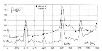
Bild 8. Leistungsspektren der Beschleunigungssignale der Geber h (untere Schütze, vertikale Messrichtung) und k (untere Schütze, Mitte unterster Hauptträger, horizontale Messrichtung) bei horizontaler Anregung durch den Exzenter mit einer Anregungsfrequenz von ca. 10,6 Hz. Ein starker Resonanzpeak tritt bei 32 Hz sowohl in horizontaler als auch in vertikaler Richtung auf, was ein Indiz für die Kopplung der beiden Bewegungsrichtungen ist.
