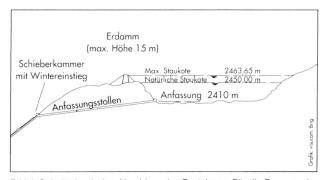
Bild 4. Schnitt durch den Abschluss des Bortelsees. Für die Fassung des Seewassers musste der See zuerst abgesenkt werden. Der Anfassungsstollen wurde von unten vorgetrieben.
