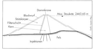
Bild 5. Schnitt durch den 310 m langen und bis 15 m hohen Steinschüttdamm. Das Dammvolumen beträgt 105 000 m³
