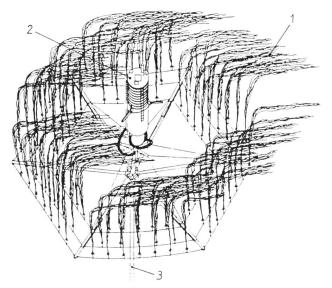
Bild 1. Die Kelpversuchsfarm vor Laguna Beach (Kalifornien). 1 Riesenkelp (Macrocystis); 2 Boje mit Instrumenten, Motoren, Pumpe; 3 Nährstoffleitung, 450 m lang, Durchsatz 30 000 I/min. Der Aussendurchmesser der Struktur beträgt etwa 32 m (aus: W. J. North, V. A. Gerard, J. S. Kuwabara, W. M. Keck, Caltech: «Biomass Production by Freshwater Marine Macrophytes». 1980).
