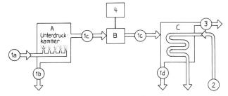
Bild 6. Schema des offenen Kreislaufes – Claude-Zyklus (Zeichnung: *Cyrill Engel*). A Verdampfer, B Niederdruckdampfturbine, C Kondensator, 1 Kreislauf des warmen Oberflächenwassers, 1a Oberflächenwassereintritt, 1b Abfluss von nicht verdampftem Wasser (~ 99,5% von 1a), 1c Niederdruckdampf, 1d entsalztes Wasser, 2 Kühlwasserkreislauf, 3 Gasabzug, 4 Generator.
