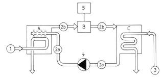
Bild 5. Schema der Wärmeenergienutzung im geschlossenen Kreislauf (Zeichnung: *Cyrill Engel*). A Verdampfer, B Niederdruckdampfturbine, C Kondensator, 1 Kreislauf des warmen Oberflächenwassers, 2 Kreislauf der Arbeitsflüssigkeit (Freon, Ammoniak), 2a flüssig, 2b dampfförmig, 3 Kühlwasserkreislauf, 4 Umwälzpumpe, 5 Generator.
