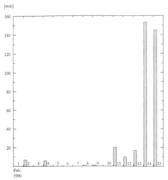
Bild 1. Gemessene Niederschlagshöhen zwischen dem 1. und 15. Februar 1990 in Wattwil (SG).
