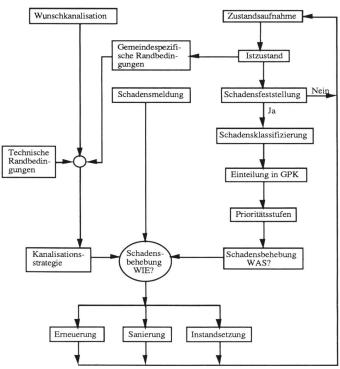
Bild 6. Vorgehensplan zur Schaffung eines dauerhaften Kanalnetzes.
