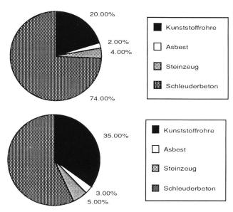
Bild 4. Aufteilung der Kanalisationsrohre nach Werkstoffen. Oben die bisherige Aufteilung, unten die Aufteilung, wie sie gemäss der Befragung in Zukunft aussehen dürfte.
